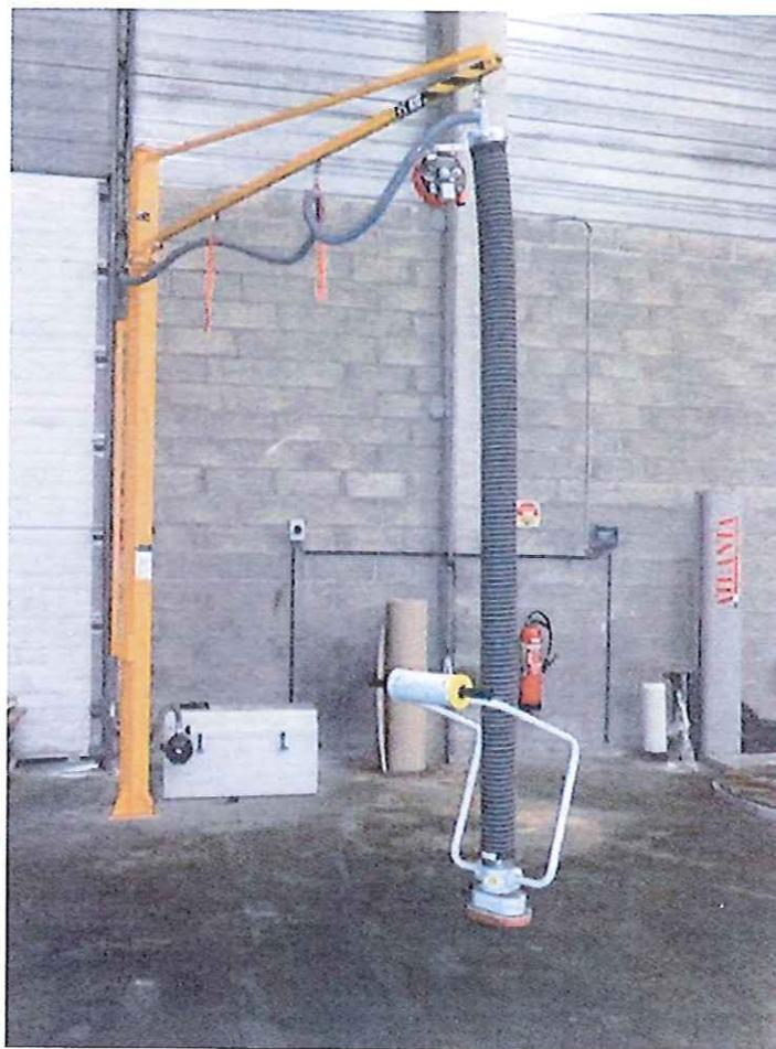
Mise en place d'un manipulateur de sacs par aspiration (ventouse).
